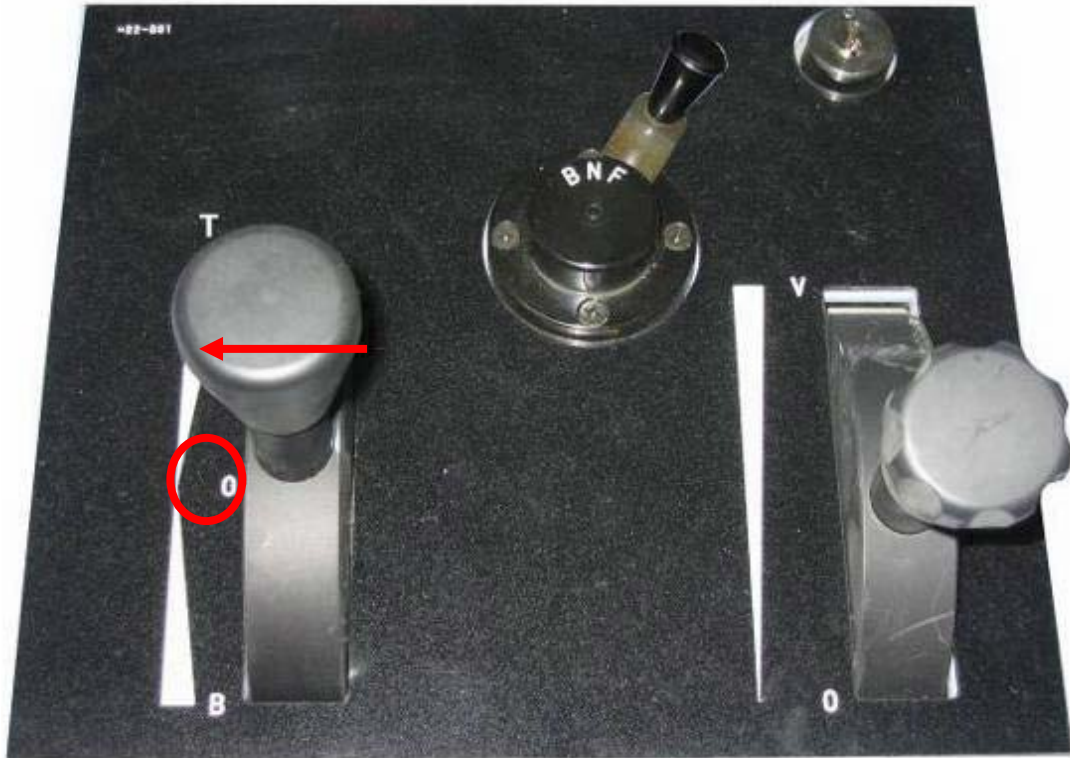
图 138 司机控制器的牵引制动手柄在 0 位置
