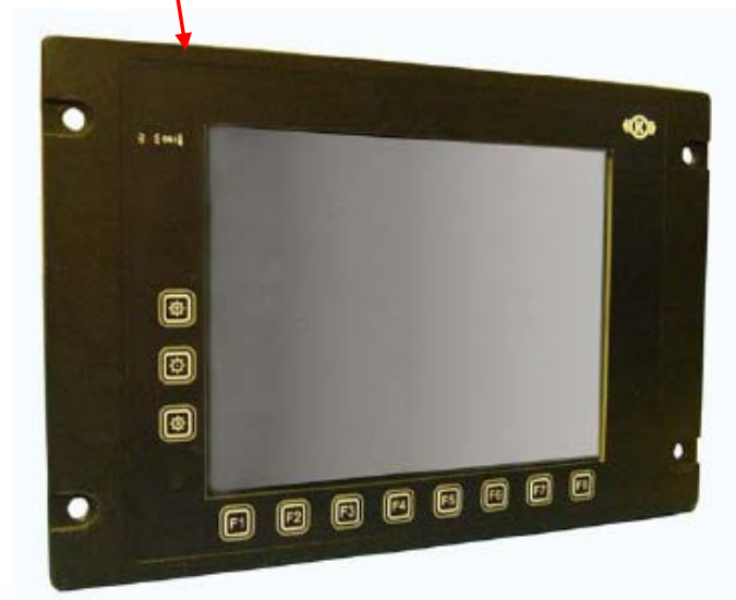
图 45: 机车司机室显示屏模块 IP-205
