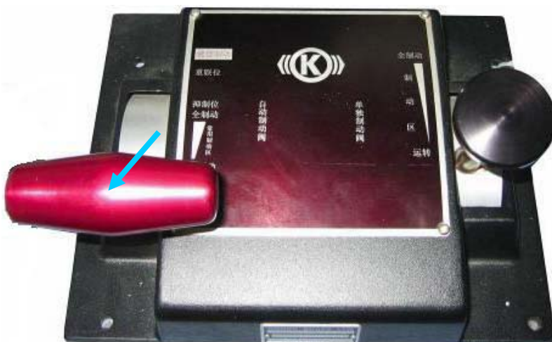
图143: EBV 上的自动/间接制动手柄
