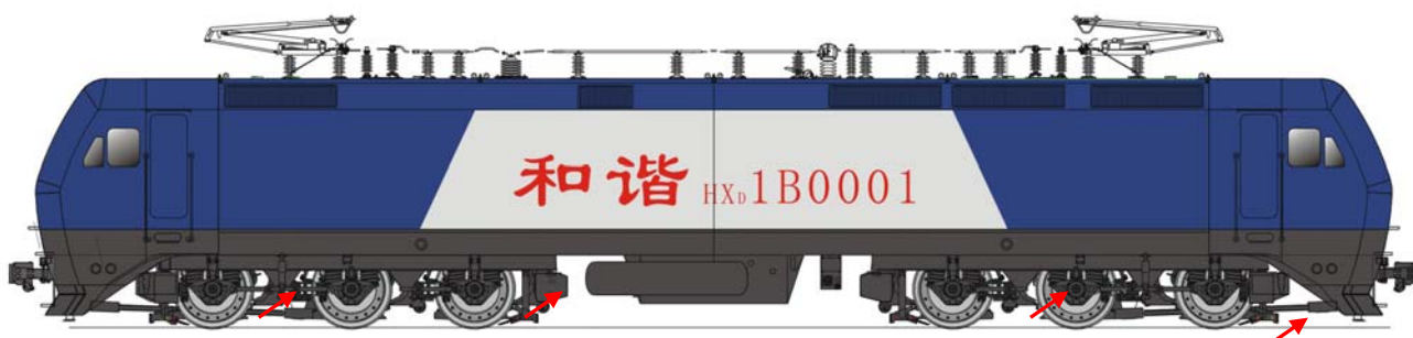
图 133: 机车、转向架、停放制动的机械缓解
