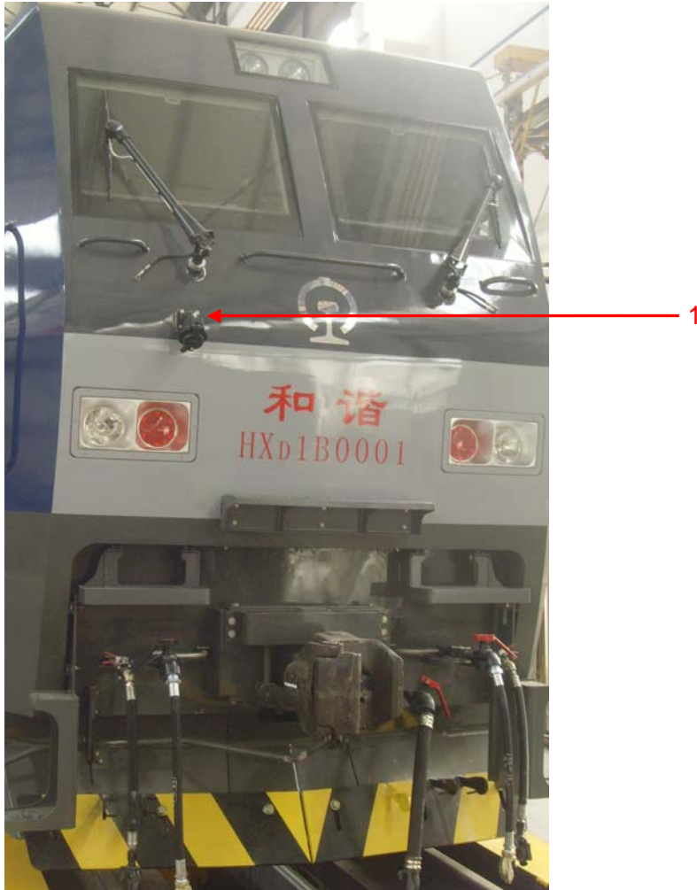
图 123: 机车前部的电气重联
