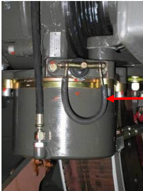
图 76：“停车制动”截止阀 B01B40.06
