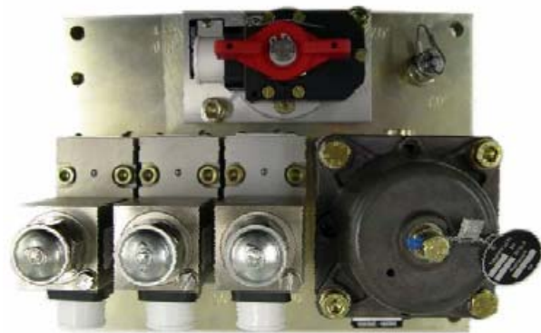
图 84: 撒砂控制单元[F41]
