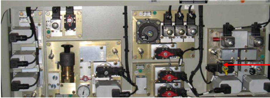
图 76：“停车制动”截止阀 B01B40.06
