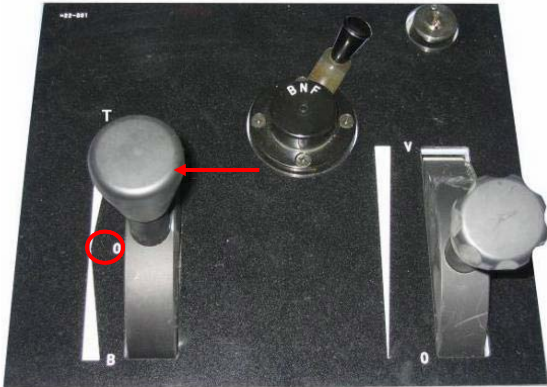
图146：司机控制器的牵引制动手柄在位置0
