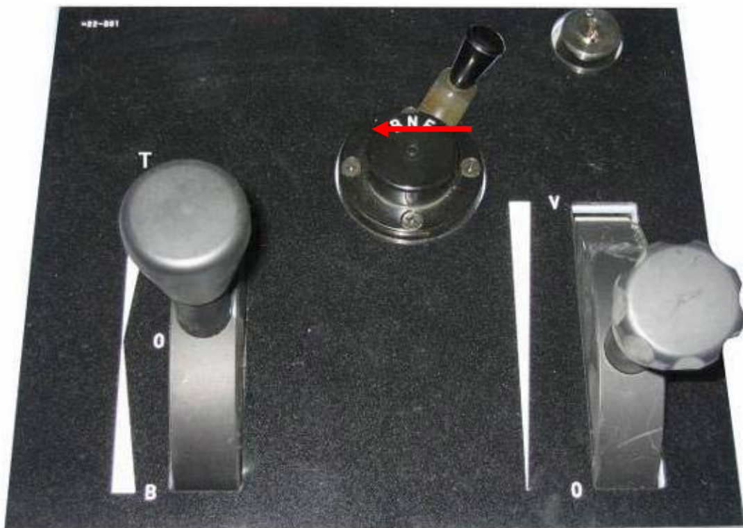
图 136: 司机控制器上的方向开关
