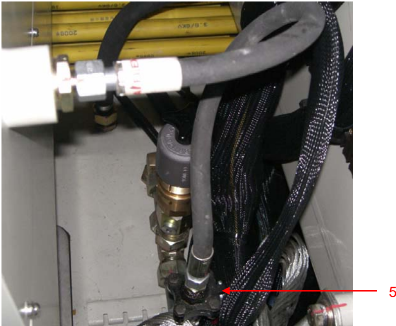
图 80：截止阀 Z10（关闭）
