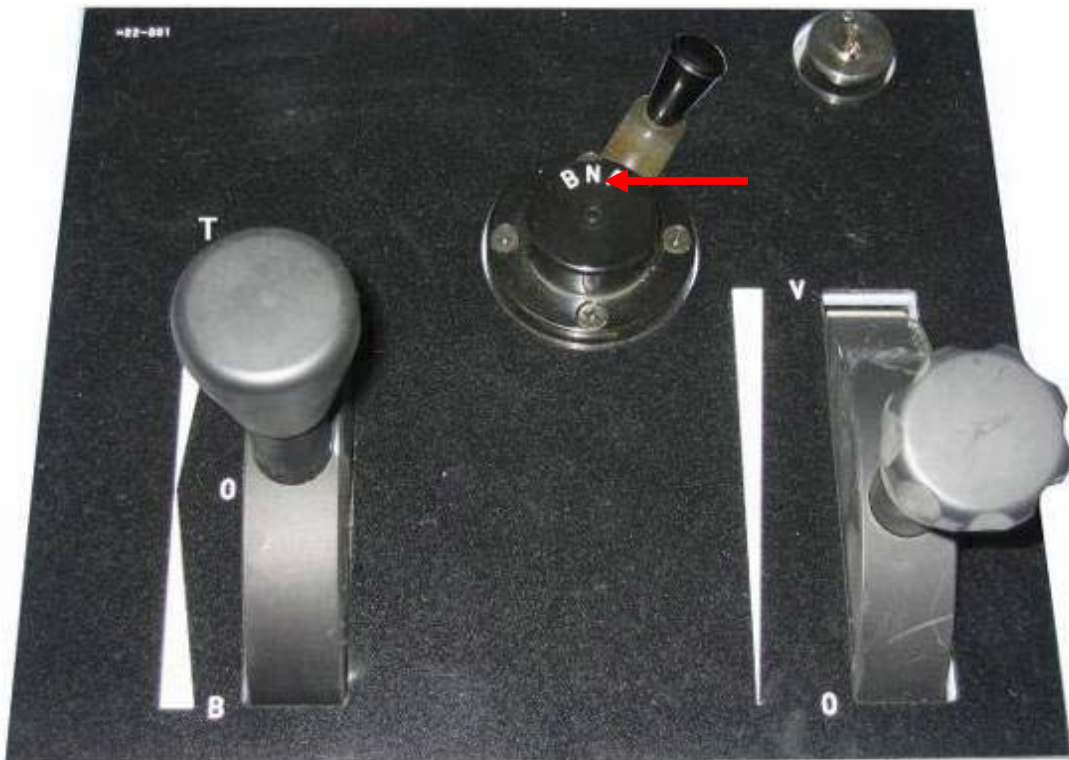
图144：司机控制器上的方向开关
