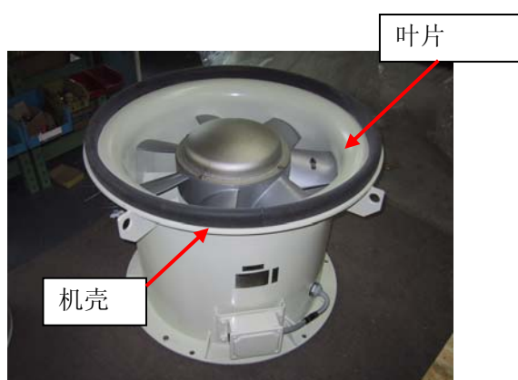
图 9-1 牵引通风机组构造图（进风侧）
