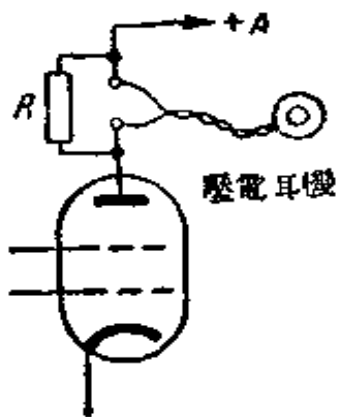
圖4.38 壓電耳機的連接電路圖
