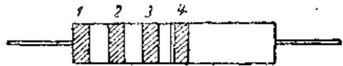
圖 4.2 用顏色腰圈標示電阻阻值的方法
