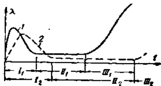
图 4 在額定条件和輕負荷条件下故障频率与时间的关系曲线：
