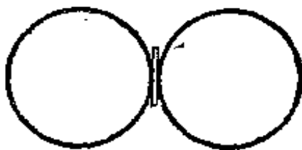
圖46. 水平振子在水平面的發射特性曲綫
