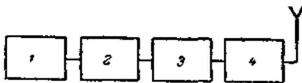
圖23.他激式發射機方塊圖 1—主振振盪器；2—緩衝級； 3—倍頻器；4—末級放大器。
