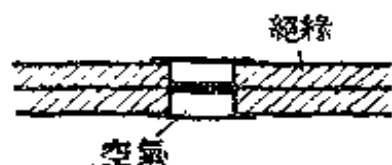
圖63. 兩段同軸電纜的正確連接
