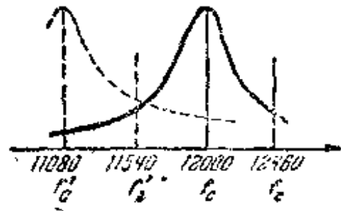
圖 30. 調諧到象頻時收音機輸入諧振電路的諧振曲線
