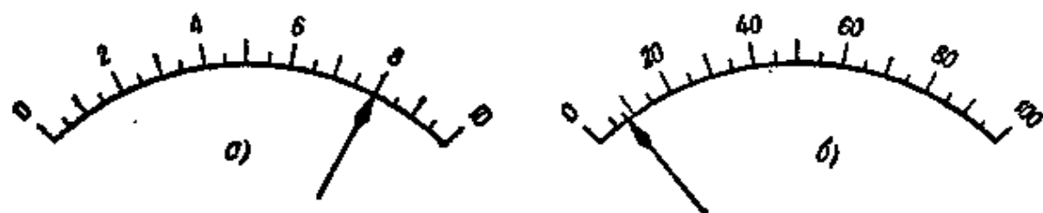
圖 2 測量 8 伏特的電壓時指針的偏移。
